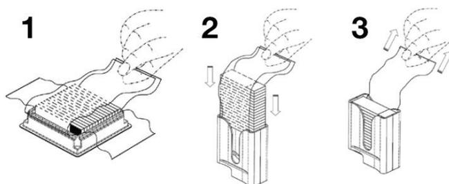
Les lames sont placées dans une enveloppe spéciale qui facilite l'insertion dans le chargeur de l'imprimante SlideMate AS et prévient toute contamination pendant la manipulation.
