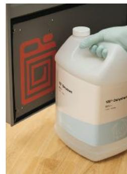
Il sistema di gestione intelligente dei reagenti, di cui è dotato lo strumento, monitora e registra l'uso dei reagenti. Ricorda ogni flacone caricato, i protocolli eseguiti e il service effettuato, consentendo ai laboratori di utilizzare i reagenti in modo più efficiente.
