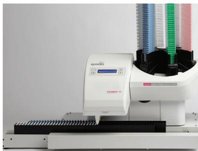
La stampante per cassette Epredia PrintMate AS può essere utilizzata per la stampa in batch di cassette con sistema di raccolta automatizzato opzionale come mostrato.
