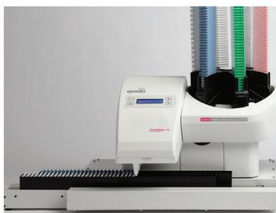
La impresora de casetes Epredia PrintMate AS se puede utilizar para casetes de impresión por lotes con un sistema de recolección automatizado opcional como se muestra.
