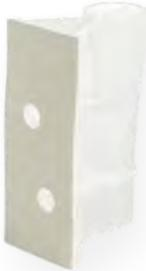
La Shandon Double Cytofunnel es una cámara de muestras descartable con tarjeta de filtro blanca y tapa.
