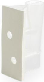
Le Cytofunnel double de Shandon est une chambre à échantillons jetable avec carte filtre blanche et bouchon.
