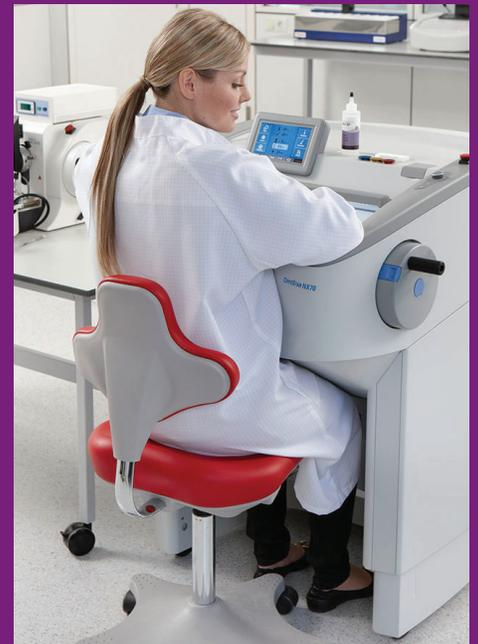
Motorisierte Höhenverstellung zur Bedienung im Sitzen oder Stehen (Standard für NX70, optional für NX50-Modelle)
