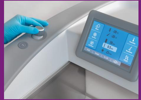
NX70 Kryostate ermöglichen motorisiertes Schneiden, um die Bedienung zu vereinfachen und sich wiederholende Bewegungen zu reduzieren
